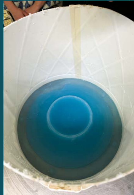
Reproduction du prototype en silicone dans le but de le dupliquer et de réaliser plusieurs moules en plâtre.
